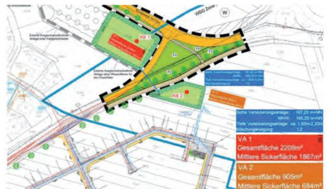
Ausschnitt Entwässerungskonzept mit Versickerungsanlagen (VA 1 und VA 2)
