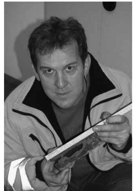
Das Bild zeigt Wassermeister Harald Schmider mit einem ausgebauten Wasserleitungsstück, das erheblichen Lochfass aufweist.
